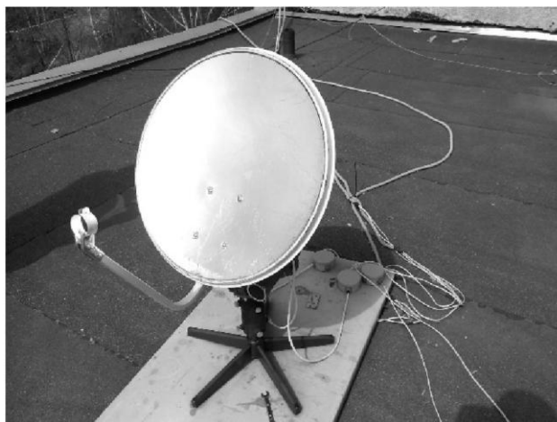
Рисунок 4.12 - Солнечный концентратор на поворотной установке
